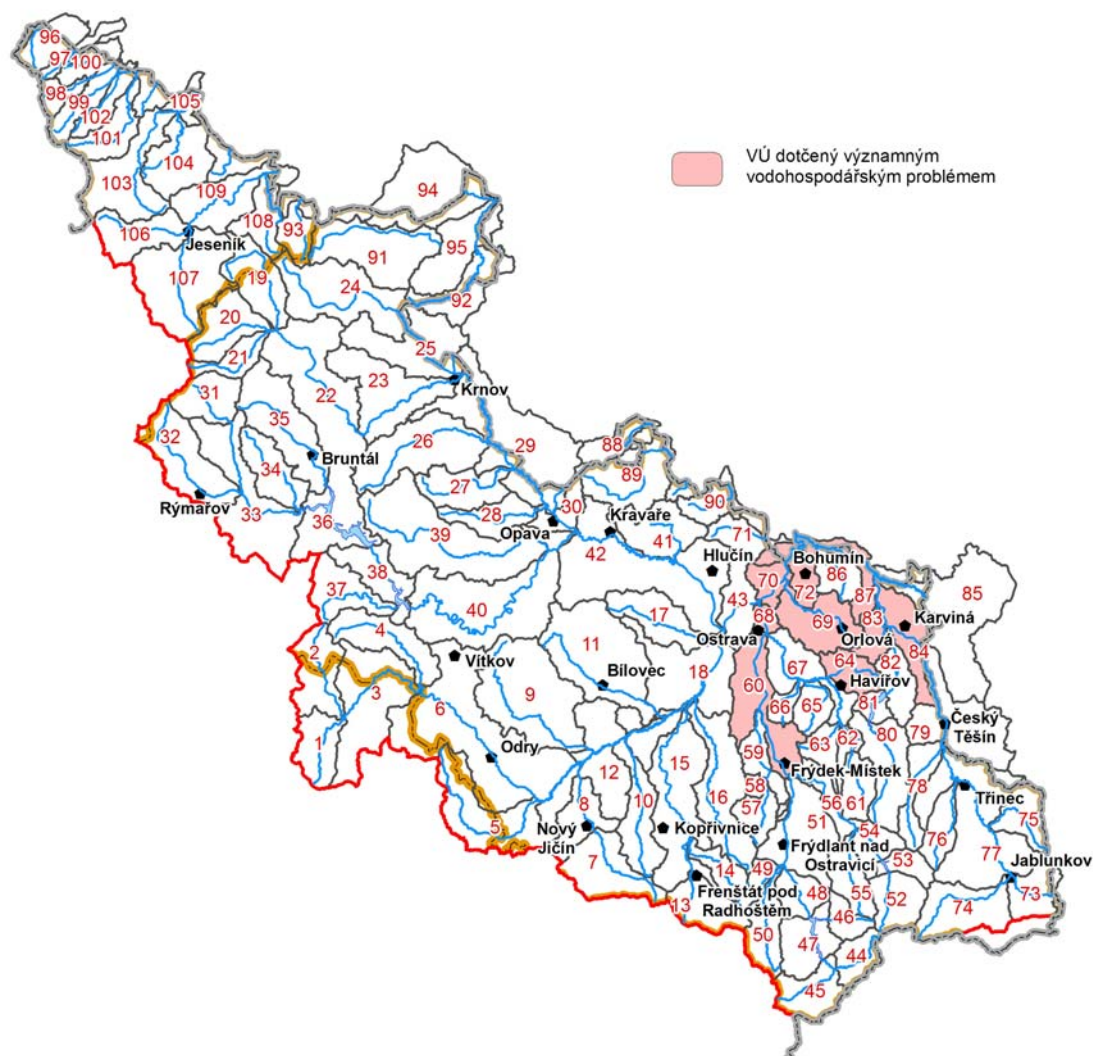
Obr. 10 Vodní útvary dotčené významným problémem „Zhoršování jakosti vod v tocích vypouštěním vysoce koncentrovaných slaných důlních vod“.
