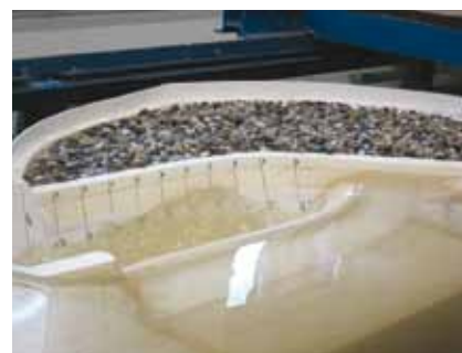
Modelová situace současného stavu při průtoku 92,7 m 3 /s
