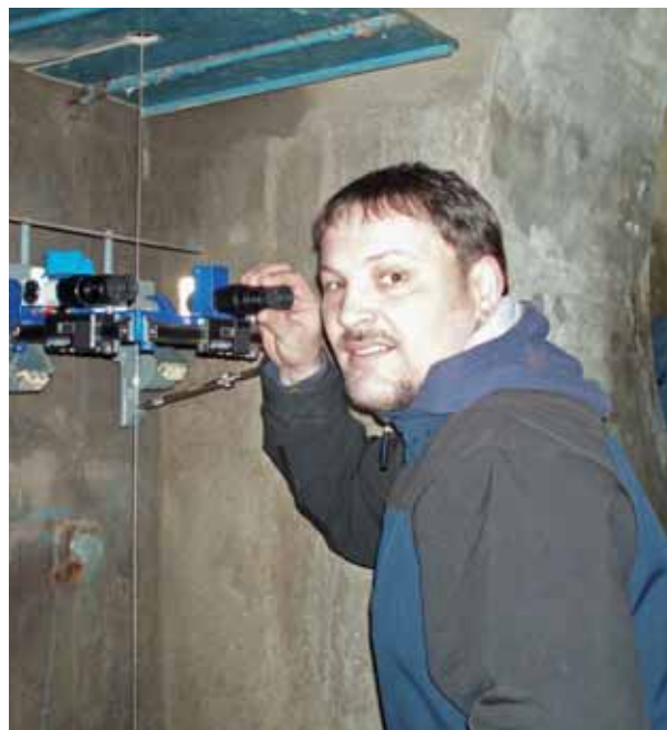
Měření hrázových kyvadel na VD Žermanice
